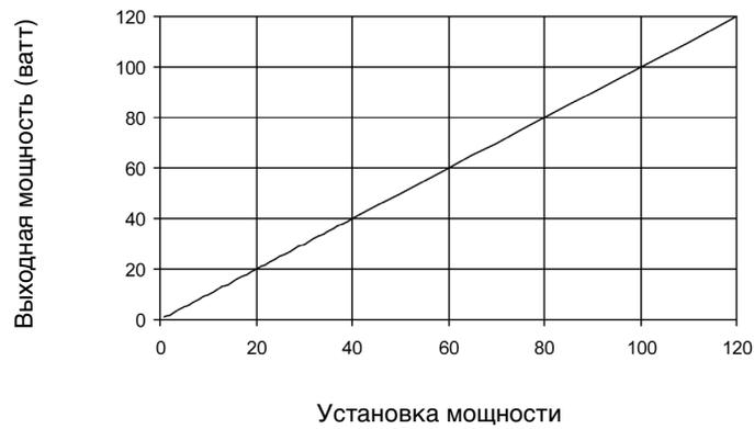
Зависимость выходной мощности от установки мощности в режиме Fulgurate (прижигания)
