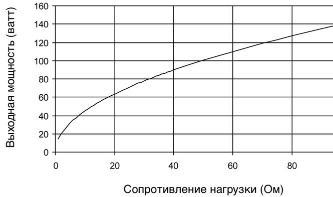
Зависимость пикового напряжения от полного сопротивления для мощности в режиме *Vipolar Low* (биполярный низкий)
