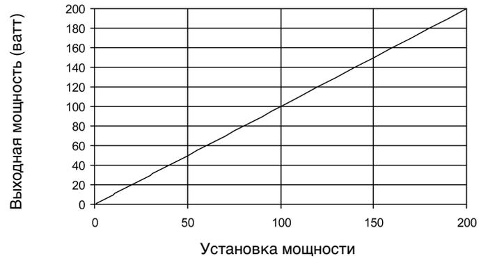
Зависимость выходной мощности от установки мощности в режиме Blend (смешанном)
